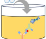
5、每孔加入100  $\mu$ L TMB终止液，轻轻震荡混匀，用酶标仪在450 nm 波长测量各孔的OD值。
